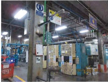
ภาพที่ 2.2-36 อ่างล้างตาและฝักบัวฉุกเฉิน
