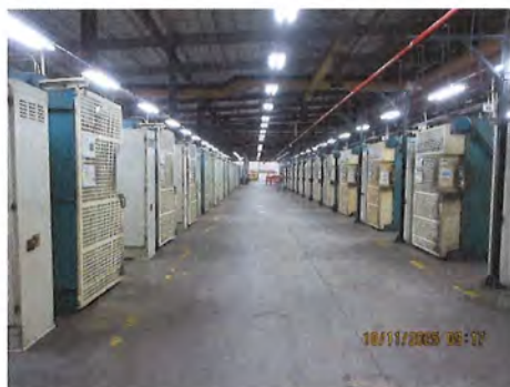
ภาพที่ 2.2-3 การติดตั้งเครื่องจักรภายในอาคารและติดตั้งอุปกรณ์เพื่อควบคุมเสียงที่มีแหล่งกำเนิดจากเครื่องจักร
